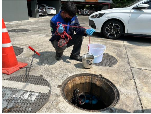
รูปภาพที่ 3.4-6 การตรวจวัดคุณภาพน้ำทิ้ง บริเวณที่ตรวจวัด : น้ำทิ้งที่ผ่านการบำบัดจากระบบบำบัดน้ำเสีย อาคาร B
