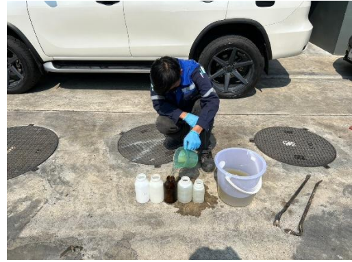
รูปภาพที่ 3.4-3 การตรวจวัดคุณภาพน้ำทิ้ง บริเวณที่ตรวจวัด : น้ำเสียก่อนเข้าระบบบำบัดน้ำเสีย อาคาร A
